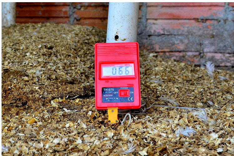
Figura 7. Monitoramento da temperatura do material em compostagem.
