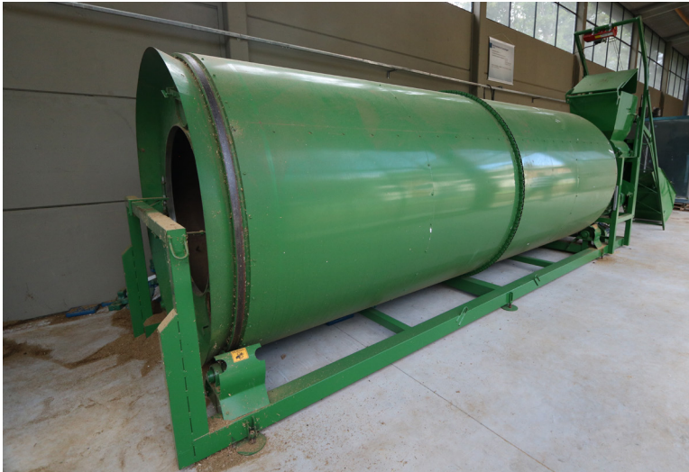
Figura 2. Equipamento de compostagem acelerada do tipo cilindro rotativo.
