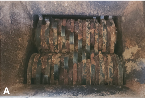
Figura 9. Trituradores de carcaça de animais do tipo eixos paralelos de baixa rotação (A) e de faca e contra-faca de alta rotação (B).
