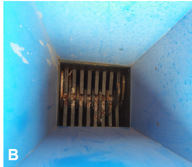
Figura 9. Trituradores de carcaça de animais do tipo eixos paralelos de baixa rotação (A) e de faca e contra-faca de alta rotação (B).
